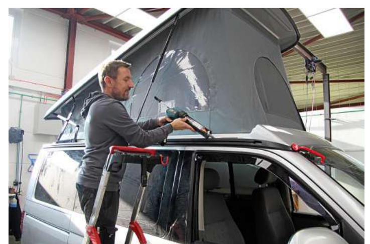
Mitarbeiter Michael Scharf bringt neben dem Schlafdach eine Autodachrinne an, an der zudem eine Markise befestigt werden kann.
